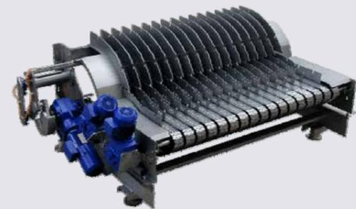
Flascheneinschub mittels Einfingersystem auf einer Kurbelschwinge. Durch drehbare Lagerung der Finger wird eine verschleißarme Einfingerringabschaltung realisiert. Ein vollständiger Aufbau in Edelstahl stellt eine lange Nutzungsdauer bei niedrigem Wartungsaufwand sicher!
