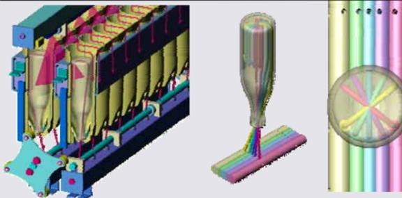
Selbstreinigende Drehrohrspritzsysteme für die Innen- und Außenreinigung der Flaschen erhöhen die Zuverlässigkeit und senken den Wartungsaufwand! Die Kombination aus Schrägspritzung mit der konventionellen geraden Drehrohrspritzung sichert eine allseitige Ausspülung der Flaschen.
