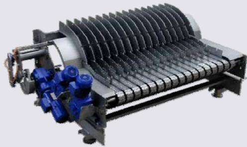
Flascheneinschub mittels Einfingersystem auf einer Kurbelschwinge.
