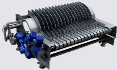
Flascheneinschub mittels Einfingersystem auf einer Kurbelschwinge. Durch drehbare Lagerung der Finger wird eine verschleißarme Einzelfingerabschaltung realisiert. Ein vollständiger Aufbau in Edelstahl stellt eine lange Nutzungsdauer bei niedrigem Wartungsaufwand sicher!
