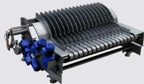
Flascheneinschub mittels 2-Fingersystem auf einer Kurbelschwinge.
